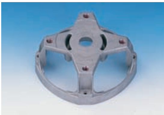
Sostegno motore in alluminio di una macchina per giardinaggio. Antisvitamento garantito da HELICOIL® plus SCREWLOCK® M 8 x 12
