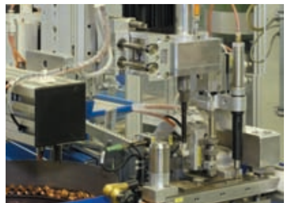
Unità di posa automatica per filetti HELICOIL® plus M 8 SCREWLOCK®.
