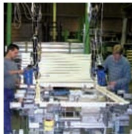
Utilizzo manuale del sistema di rivettatura con monitoraggio del processo. Nella foto assemblaggio porte/cancelli.
