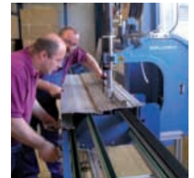
Produzione di condotte per l'aria condizionata con un sistema integrato.
